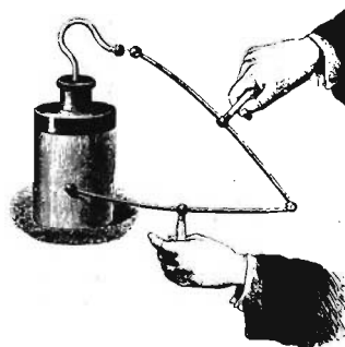
Scarica istantanea di una bottiglia di Leyda mediante un eccitatore, che mantiene isolate le mani dell'operatore.
